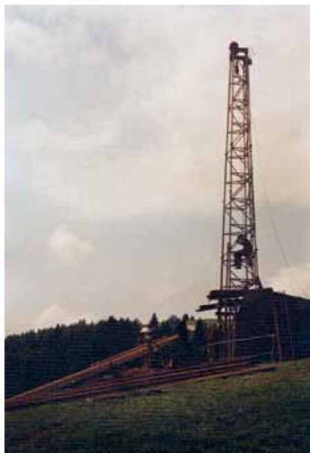
Obseg rudišča, položaj orudenja in kakovost rude smo določali predvsem z vrtanjem s površine in iz jame. V vsem obdobju je bilo v rudišču Žirovski vrh izvrtano 64.000 m strukturnih vrtin. Vrtina B-60, v bližini kmetije Sive, je bila globoka 423 m. (foto: Tomaž Budkovič)
