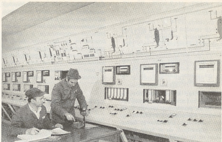
Komandna kabina linije proizvodnje celuloze, kjer so združeni instrumenti, ki kažejo potek procesa z zasledovanjem temperatur, pritiskov in pretokov. S tega mesta daljinsko vodimo procese kuhanja, pranja, prebiranja in beljenja celuloze.
