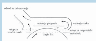
□ Slika 4. Skica modernega zgornjega odsesavanja (Prodinger 2000)
