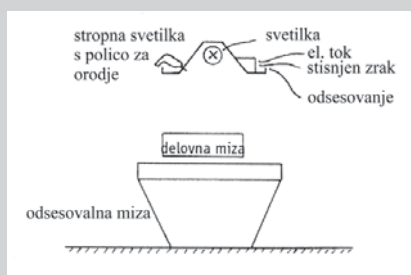
□ Slika 9. Izdelava delovnega mesta z razsvetljavo in urejenim sistemom za odsosovanje prahu (Prodinger 2000)
