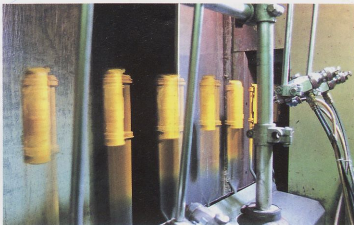
Samodejno nanašanje večkomponentne barve v komori, kjer se ohišja lokomotiv vrtijo nekaj časa v eno, nato še v drugo smer
