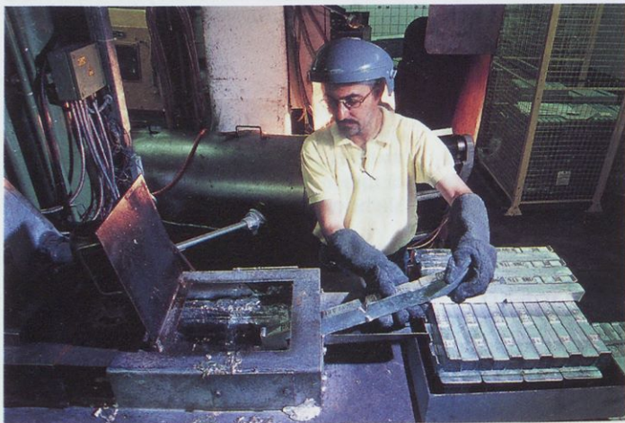
Posebna zmes cinka, aluminija, bakra in magnezija se v peči raztali in se nato v tekočem stanju dovaja v stroj za tlačno litje.
