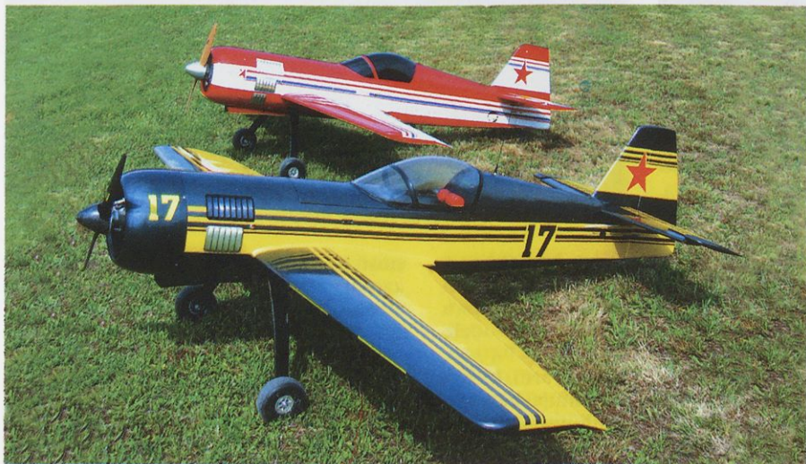
Izredna akrobatska modela suhoj Su-26 sta skonstruirana in izdelana doma. Model popolnoma klasične gradnje žene bencinski motor MVVS 26 cm 3 z resonančno cevjo.
