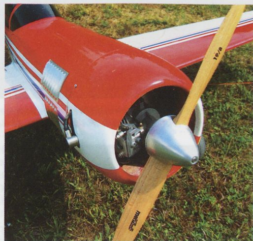
Eden izmed manjših bencinskih motorjev MVVS 26 cm 3 se odlično obnese v kombinaciji z modeli, ki tehtajo do 5 kg. Motor zanesljivo deluje in je preprost za rokovanje.
