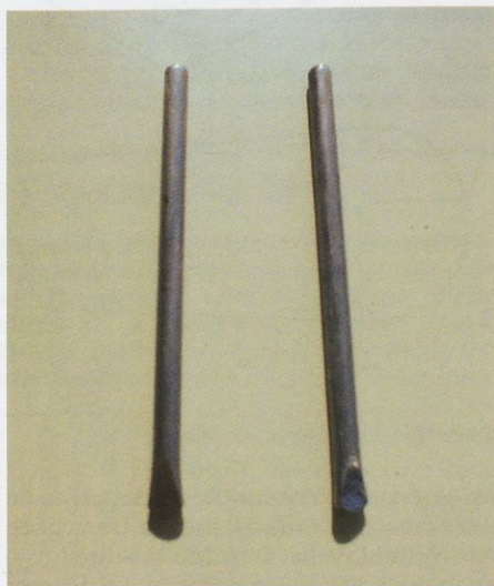
Ročici na enem koncu sploščimo z nekaj udarci kladiva, na drugem pa potem, ko vijačno spono sestavimo in paličici vstavimo v vijaka.
