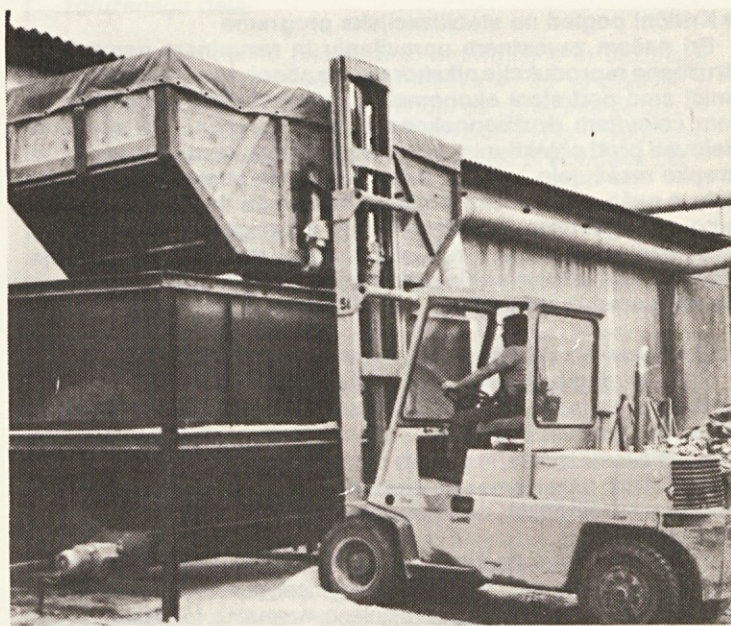
Dozirna naprava za vpihovanje pripeljane žagovine v silos
