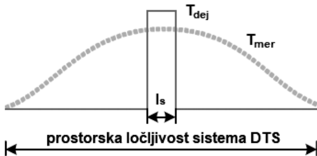
Slika 2. Razmerje med širino območja lokalne temperaturne spremembe in prostorske ločljivosti DTS [Hoffmann, 2007].
