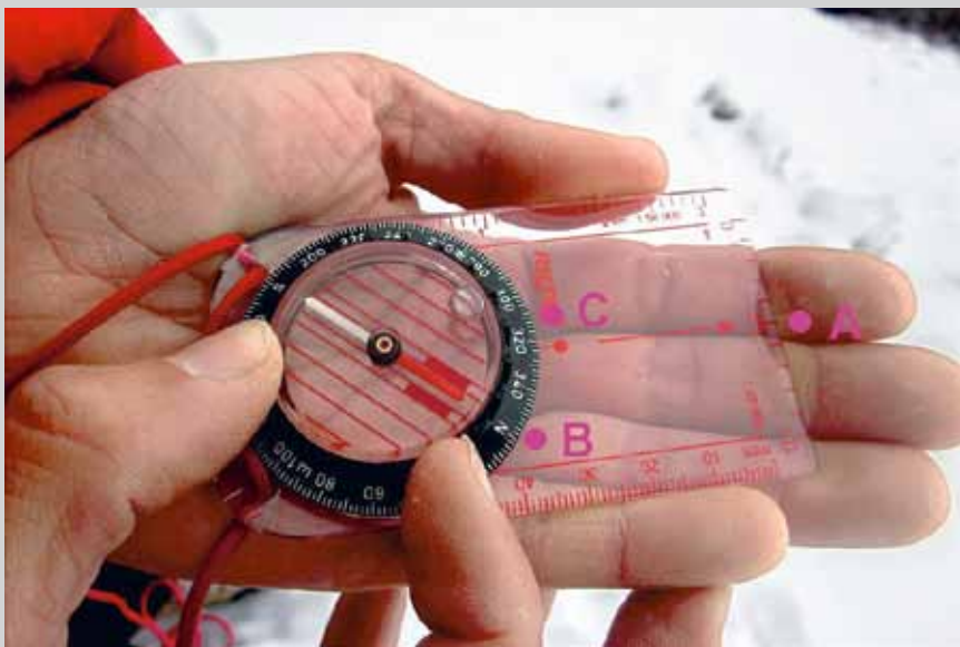
Slika 2: Kompas obrnemo proti objektu tako, da je puščica na prozorni ploščici (A) usmerjena proti merjenemu objektu. Limb vrtimo, dokler se magnetna igla in oznaka severa na limbu ne poravnata (B). Pri označbi na vrhu kompasa (C) odčitamo smer, 320°. FOTO: BLAŽ GRAPAR
