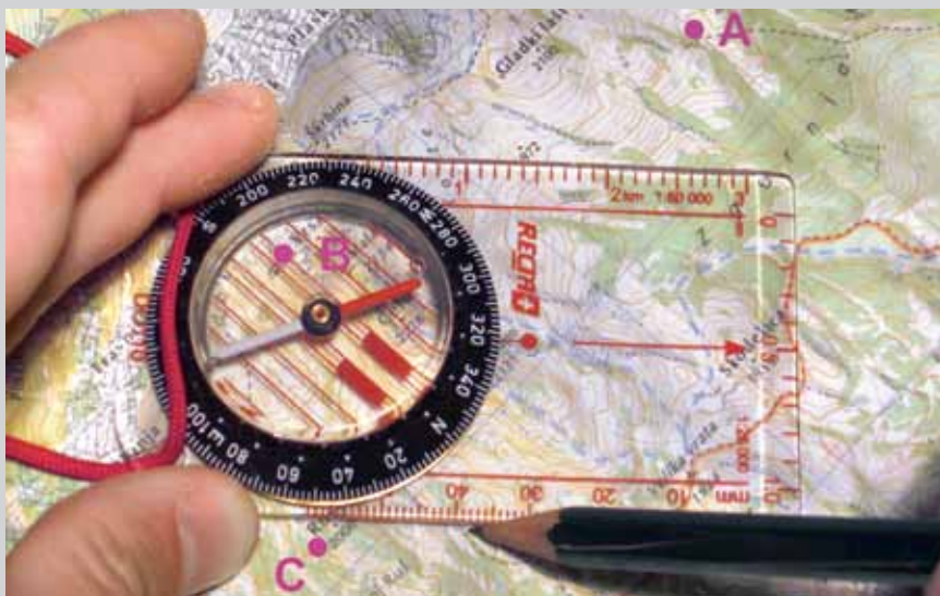
Slika 3: Pri vrisu kontraazimuta si lahko namesto kotomera pomagamo tudi s kompasom. Usmerjenost magnetne igle tu ni pomembna. Z nastavljenim izmerjenim azimutom ( 320^\circ ) poravnamo črte v limbu (B) in črte na karti, (A) ki označuje sever. Pazimo, da narišemo kontraazimut in ne azimuta. Rob kompasa postavimo ob točko, na katero smo merili (C) azimut. Narišemo črto od točke v smer, ki jo določa rob kompasa. FOTO: BLAŽ GRAPAR
