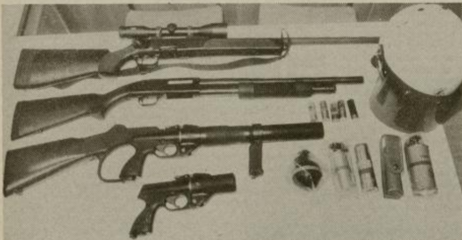
Orožje in oprema specialcev (od zgoraj navzdol): ostrirovelna puška SSG-69, puška »pumparica«, puška »schermully« za izstreljevanje plinskih nabojev, pištola »schermully«, ob strani pa še sredstva za pasivizacijo (plinske ročne bombe, plinski naboj in plinski spray ter intervencijska čelada).
