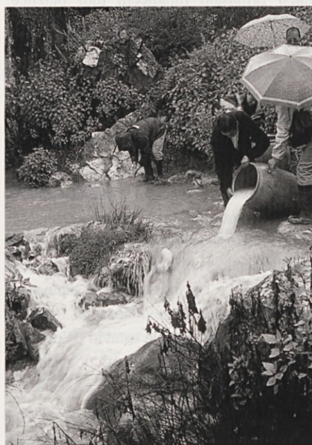
Slika levo zgoraj: Zajemanje prenikle vode in meritve v jami Baiyun. Foto: M. Knez. Slika levo spodaj: Sledilni poskus - Injiciranje fluorescentnega sledila v vodni tok v podzemni jami Wayao. Foto: T. Slabe. Slika levo: Injiciranje natrijevega klorida v vodni tok na točki Qinhuadong. - Foto: J. Kogovšek.
