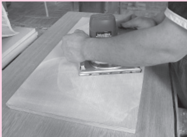
□ Slika 5. Brušenje lakirane površine – brušenje temeljnega laka
