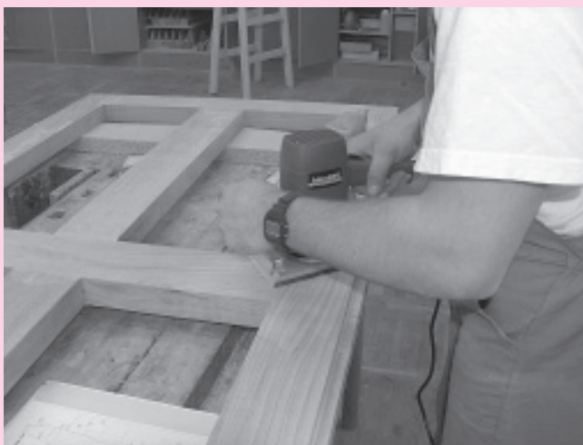
□ Slika 4. Brušenje na spoju pri različnih smereh rasti lesa (delo na projektnem izdelku tehnika v šolskih delavnicah)
