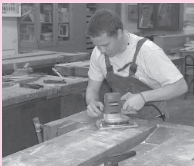
□ Slika 6. Uporaba vibracijskega brusilnika pri obnovi skobeljnikov v šolskih delavnicah
