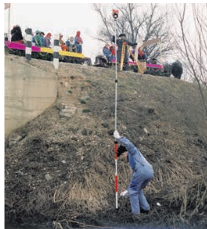
Inženiring Šota ugotavlja geodetski posnetek višine od nivoja terena, do vrha ceste
