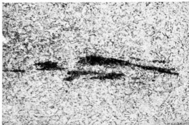
Slika 20 Nekovinski vključki. Jedkano z nitalom (2%). Pov. 100×
