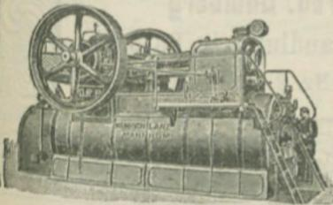
**Amtliches Prüfungsattest**, vorgenommen an einer **100 P. S. Heißdampf-Compound-Lokomobile** mit Kondensation und Ventilsteuerung System „Lantz“:
