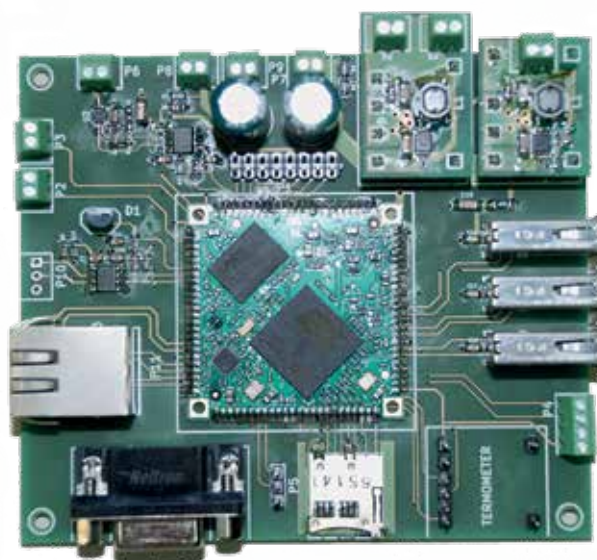
Slika 1: Procesna enota sonde – nosilna plošča z modulom Aria-G25 in priključki.
