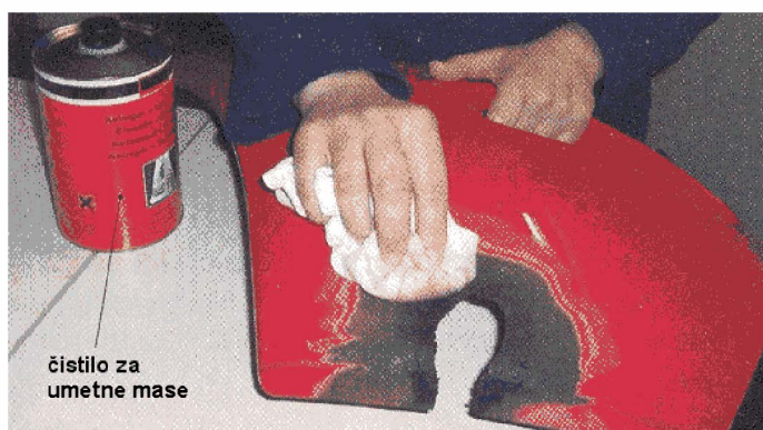
Slika 1: Predhodno čiščenje mesta popravila s čistilom za umetne mase
