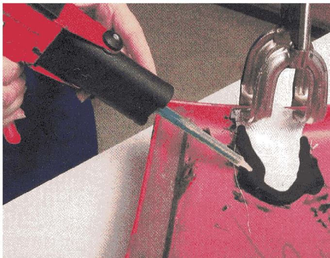
Slika 4: Nanašanje lepila na zadnjo stran popravljanega dela
