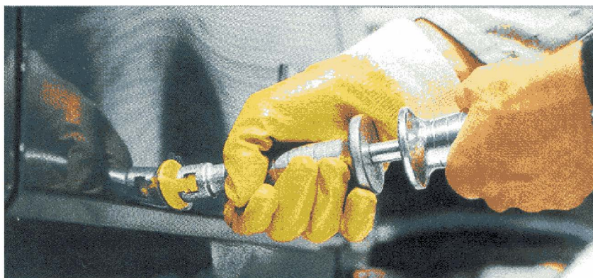
Slika 4: Vboklina s prilepljenim nastavkom
