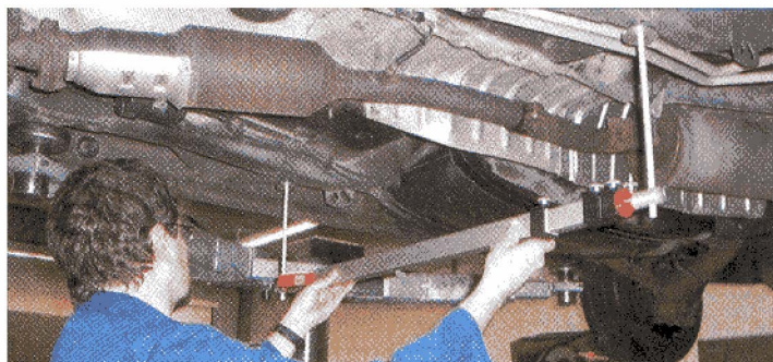
Slika 4: Merjenje s teleskopsko merilno palico
