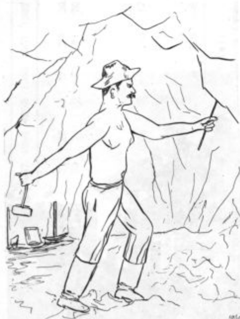
Rudar pri ročnem vrtanju v jami. Po skici slikarja-amaterja, domačina Rafaela Božiča
