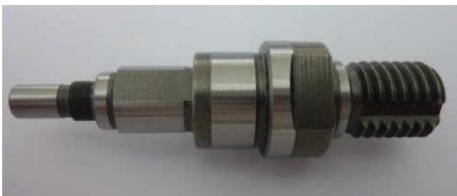
» Podjetje Metabowerke GmbH v Nürtingenu proizvajajo vretena kotnih brusilk s prevleko Tiger-tec® Silver PVD. Učinek prekaša vse doslej uporabljene rezalne kakovosti na področju poligonskega rezkanja (+300 odstotkov) in kopirnega struženja (+78 odstotkov). | Slika: Walter AG
