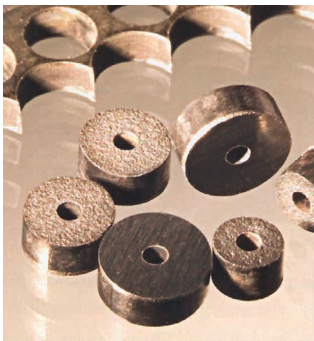
» Polizdelki za stekloreznike (premeri od 2,15 do 3,40 mm), izdelani s sistemom UltraShape II, iz polikristalinskega diamanta (PKD), v proizvodnji sodobnih LCD- in plazma zaslonov
