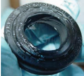
» Slika 20d: Poškodovano posnemalo.
