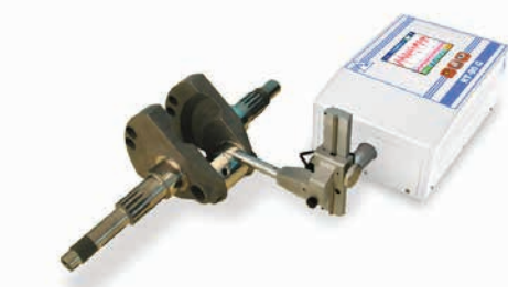
» Slika 3: Merilnik RT90 G, ki poleg običajnega merilnega območja po Z-osi uporablja še mikrometrski hod, s čimer lahko merimo tudi večje diametre
