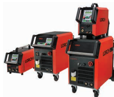
» Slika 10: Prenovljena krmilna plošča naprave omogoča, da so vsi bistveni parametri hitro in zlahka dosegljivi – Dinamiko varilnega obloka lahko varilec individualno prilagodi z trdega v mehkega z gumbom na desni.
