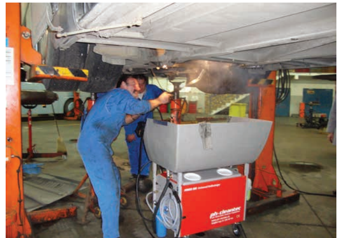
» Slika 3: Pranje z nizkim tlakom in vročo vodo.
