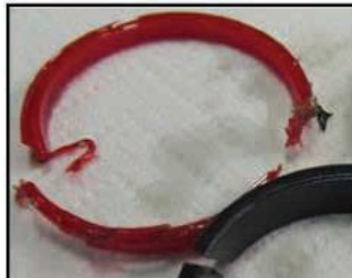
» Slika 20e: Izrabljeno HPU batno tesnilo.
