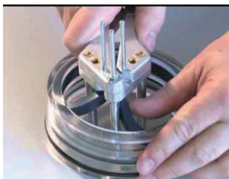
» Slika 19: Orodje za montažo notranjih tesnil (batnice).
