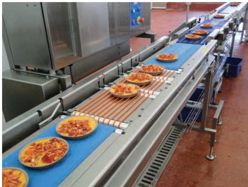
» Slika št. 1: Prikaz rešitve vgrajenega servo pogona na združevalnem transportnem traku. Pite prihajajo v naključnih časovnih presledkih.
