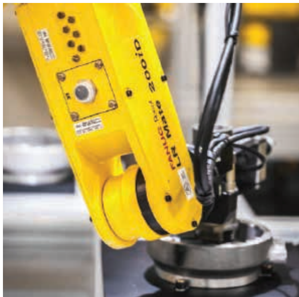
» LR Mate s prigrajenim senzorjem sil in vision sistemom izvaja odstranjevanje srha.
