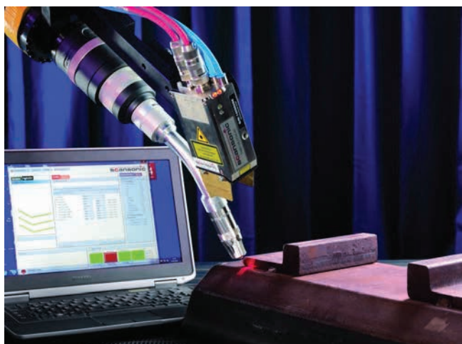
» Slika 1: Optično sledenje zvaru z opremo Abicor Binzel TH6D
