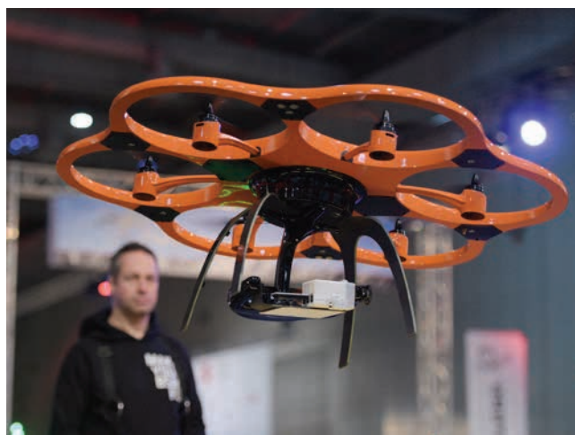
» Droni v akciji: Aibot X6 podjetja Aibotix, namenjen za avtomatizirane preglede daljnovidov, mostov, gradbišč in drugih objektov ter fotografiranje, fotogrametrijo in podobne naloge
