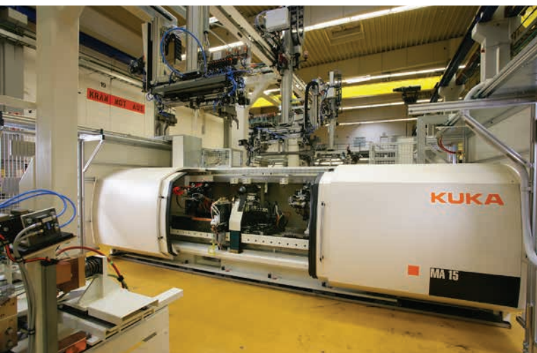
» Slika 1: Nova generacija varilne naprave za varjenje po postopku Magnetarc Kuka [3] (Foto: KUKA Systems GmbH)
