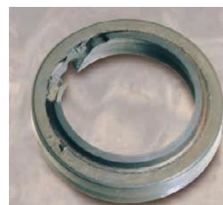
» Slika 20b: Poškodbe tesnila zaradi tlačne ekstruzije (prevelik tlak).
