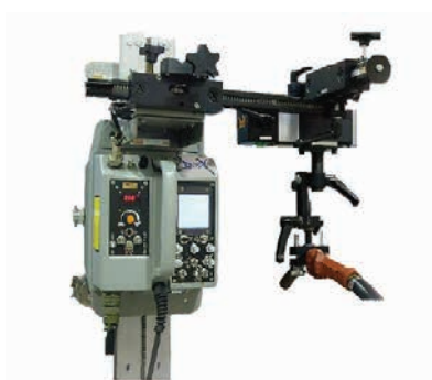
» Slika 1: Prikaz sistema za vodenje in nihanje varilnega gorilnika med varjenjem
