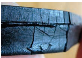
» Slika 20f: HPU tesnilo poškodovano zaradi prevelike temperature.
