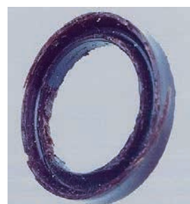
» Slika 20a: Poškodovano tesnilo zaradi vpliva kontaminacije medija (abrazija).
