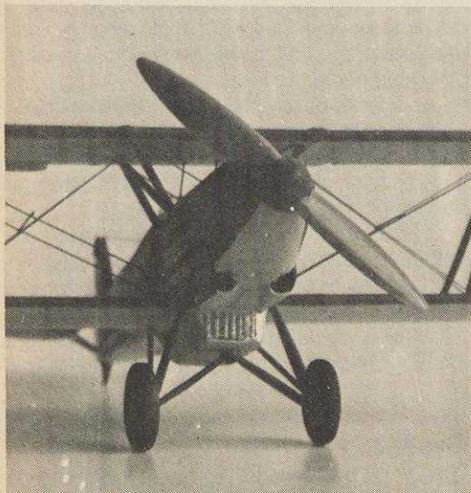
Slika 4. Avia B-534/II z lesenim vlečnim vijakom in modifikiranimi dovodi zraka
