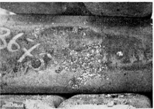
Slika 10 — vključki opeke na površini
