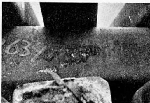
Slika 9 — žlindra na površini ingota
