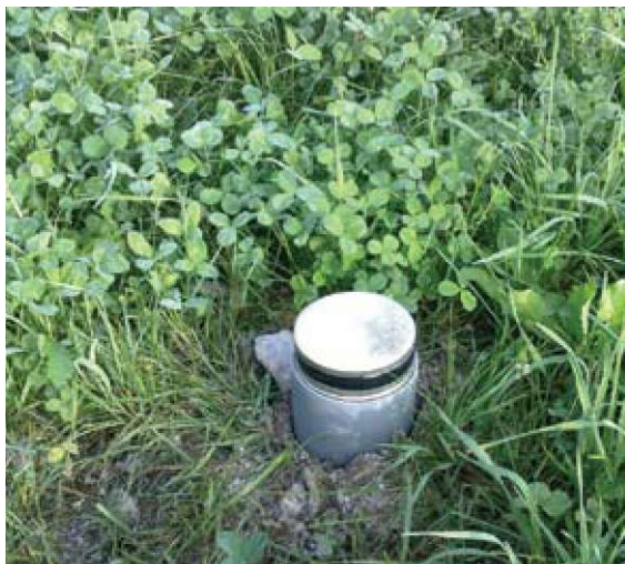
Meritve hitrosti izhajanja radona iz tal z ogljenimi adsorberji
