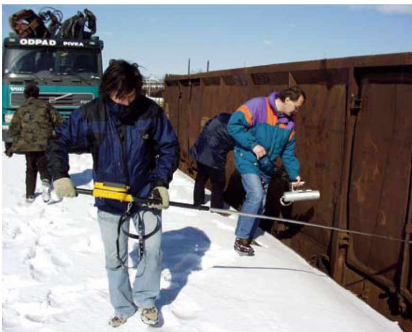
Meritve hitrosti izhajanja radona iz tal z ogljenimi adsorberji
