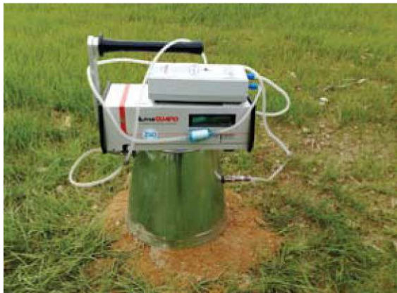
Meritve hitrosti izhajanja radona iz tal z merilnim instrumentom
