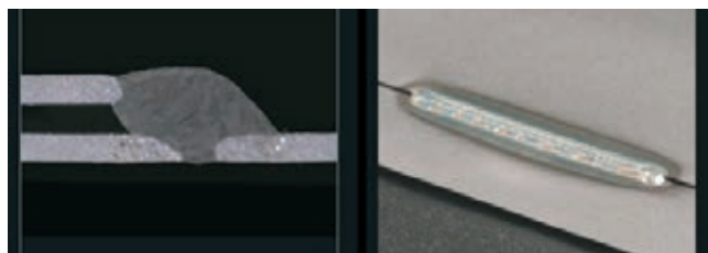
» Prekrivni spoj, debelina materiala 0,6 mm
