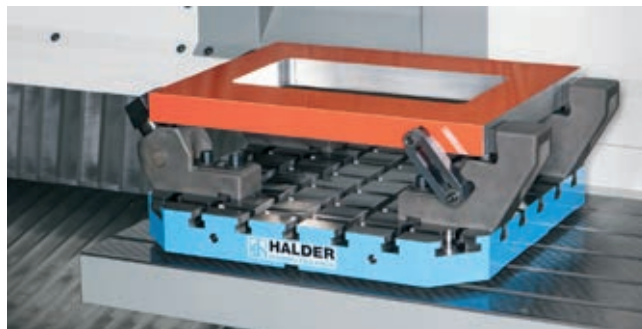
» Slika 2: Z vpenjalnimi podlogami in podložnimi nasloni je na voljo cela miza stroja za vpenjanje obdelovancev.
