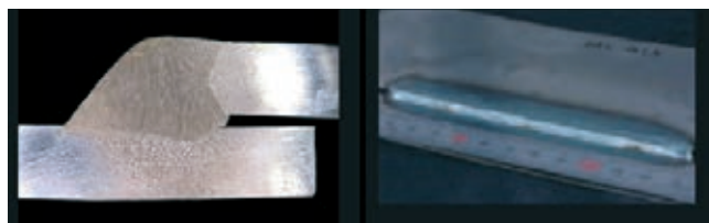
» Prekrivni spoj, debelina materiala 3 mm
