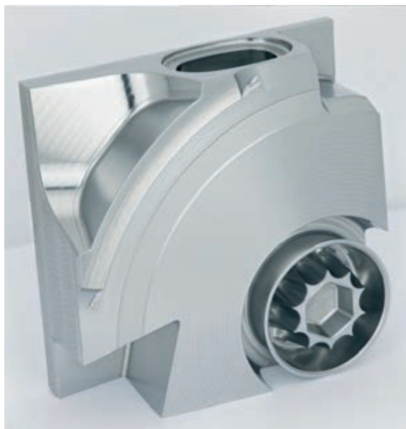
» Slika 4: Predstavitveni obdelovanec iz delavnice v Kasslu. Material je jeklo 1.2312.
