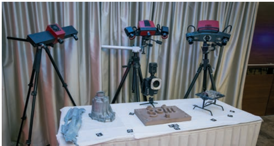
» Zgodba skenerja ATOS (z leve na desno v ozadju): prvi prototip ATOS-a, njegova druga generacija ter ATOS 2E. Čeprav se zdi kot običajni digitalni fotoaparati, je na sredini mize TRITOP, optična trikoordinatna merilna naprava.
