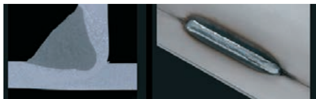
» Kotni var, debelina materiala 3 mm
