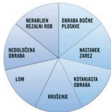
» 6. slika: Rezalna orodja se obrabijo zaradi več pojavov
