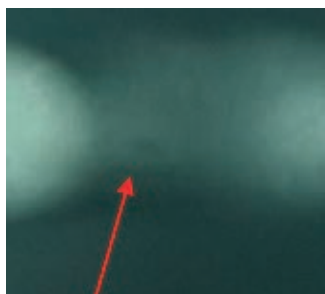
» Slika 9: Konvencionalna radiografija - Povečava napake na vzorcu 4.
