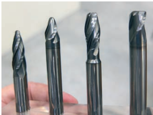
» Slika 2: Na razpolago so štiri tipi rezkarjev krožnega izseka: v kapljasti, stožčasti, sodčkasti in lečasti obliki.
