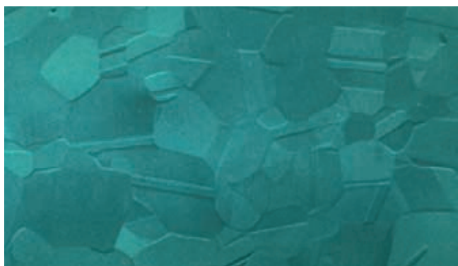
» Slika 2: Elektropolirana površina nerjavnega jekla s 30µm odstranitvijo materiala [1]
