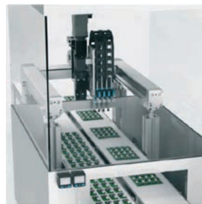
» Vgradnja generatorja podtlaka OVEL na strežno napravo
