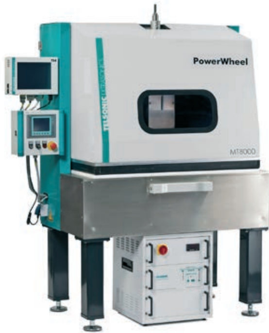
» Postopek PowerWheel® omogoča sile pritiska do 10 kN in moči do 13 kW.
