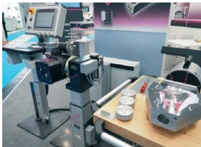
»» Slika: Ob podpori inteligentnih modulov za manipulacijo z izdelki, lahko uporabnik na primer sam montira diferencialni pogon in zavorne cilindre.
