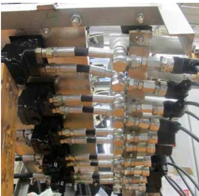
Slika 5 : Merilna mesta in delovni izhodi zavornih ventilov
