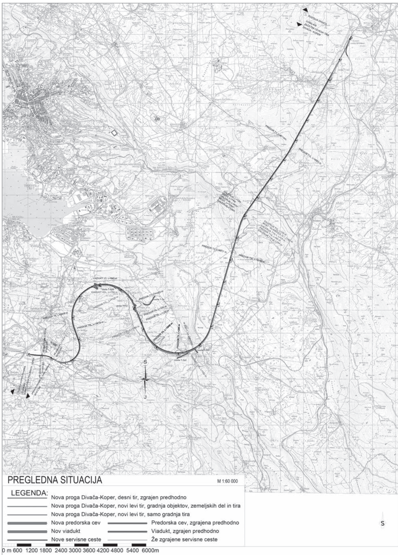
Slika 3: SD DLN za drugi tir železniške proge na odseku Divača–Koper (nadgradnja v dvotirno progo) (vir: Urbis d. o. o., 2019)
