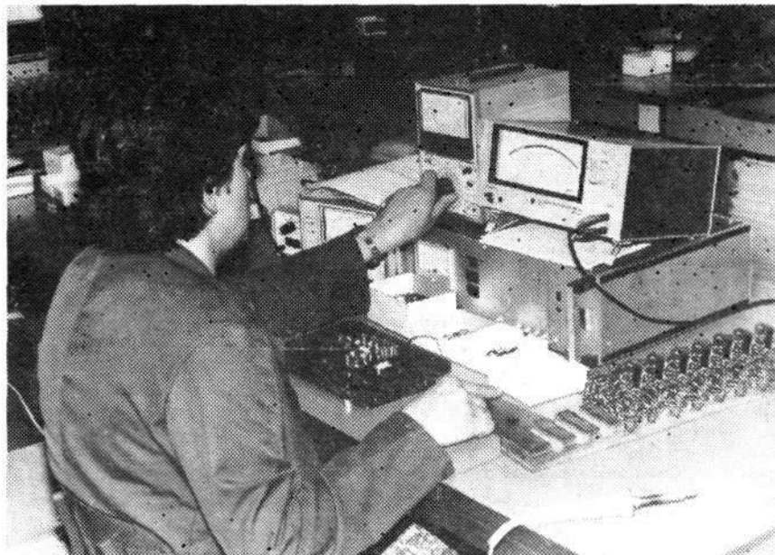
Avtomatsko merjenje pri kontroli električnega sklopa v kostanjeviški Iskri
