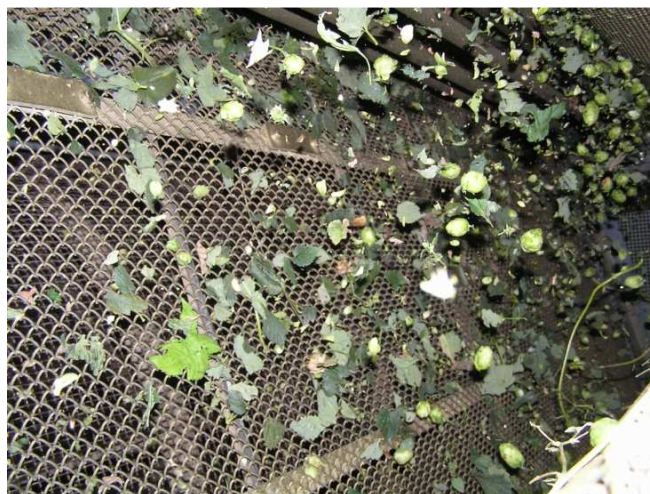
Ventilatorski čistilnik je bolj zmogljiv, ker predhodno prebere okoli 40 odstotkov storžkov (foto: Davorin Vrhovnik).
