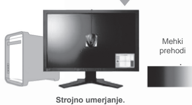
Slika 2: Osemitno programsko umerjanje povzroči zmanjšanje tonskega obsega, s strojnim umerjanjem z desetimi in več biti pa se temu izognemo.
