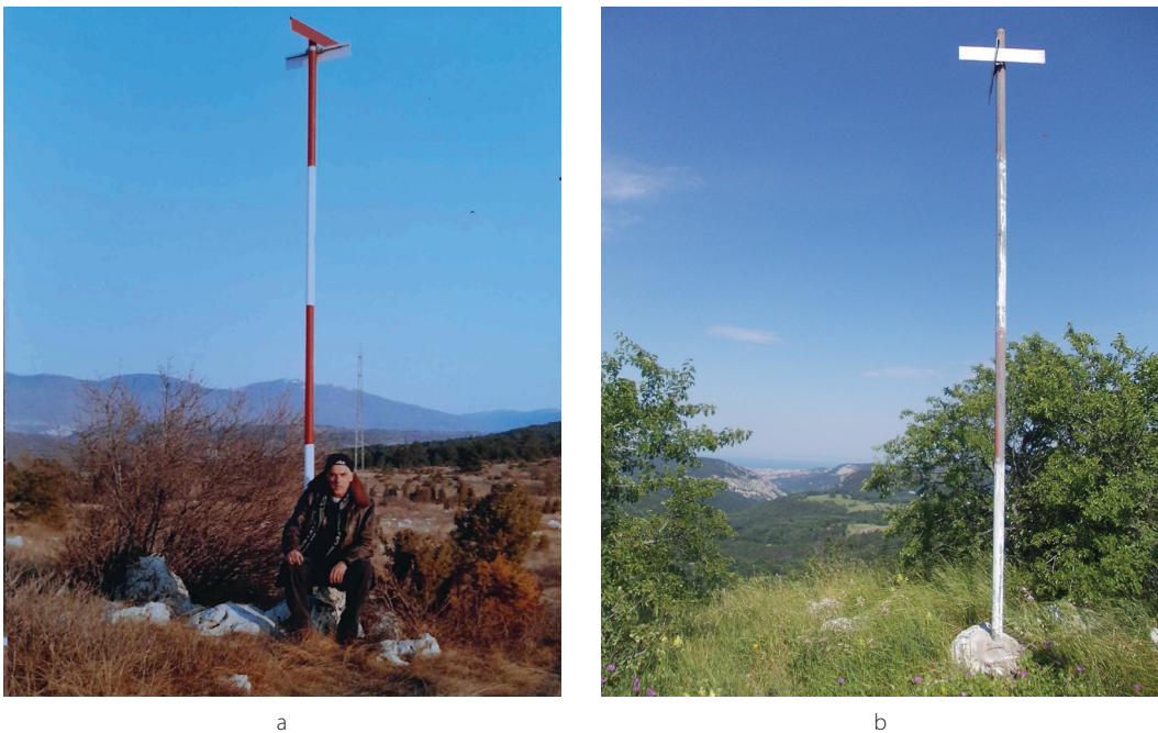
Slika 10: Kovinska signala: a) ob postavitvi leta 1996 – Soline pod Beko, III. red, št. 87 C0, trig. okraj Sežana, ob vznožju kovinskega signala sedi Ivan Lojk (foto: arhiv I. Lojk); b) danes – Črna griža, IV. red, št. 47 C0, trig. okraj Sežana (foto: R. Škafar, 2021).
