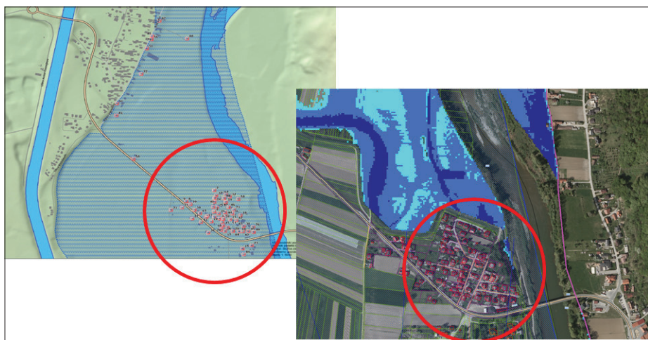
Slika 5 • Poplavna ogroženost naselja Dogoše pred in po izvedbi protipoplavnega zidu (Mestna občina Maribor, 2019).
