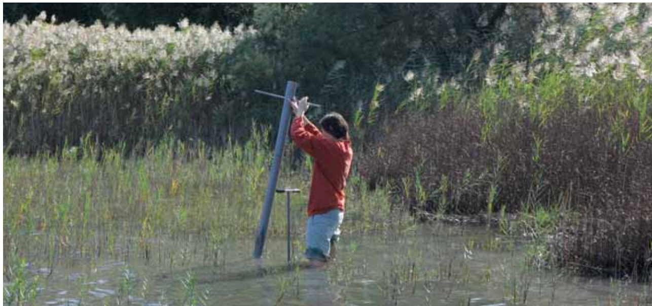
Slika 4: Uporaba kanalizacijske cevi za jemanje profila subakvalne prsti (foto: Blaž Repe).
