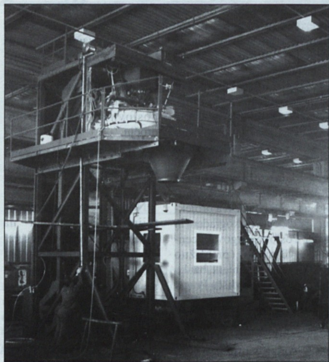
Preizkušanje betonarne v Tosinovi proizvodni hali
