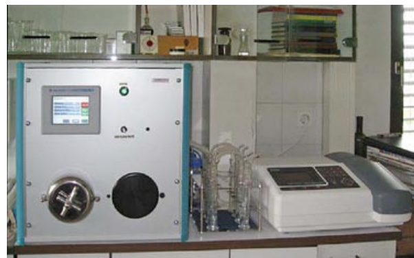
■ Naprava za določanje emisije formaldehida po standardu SIST EN 7171-2
