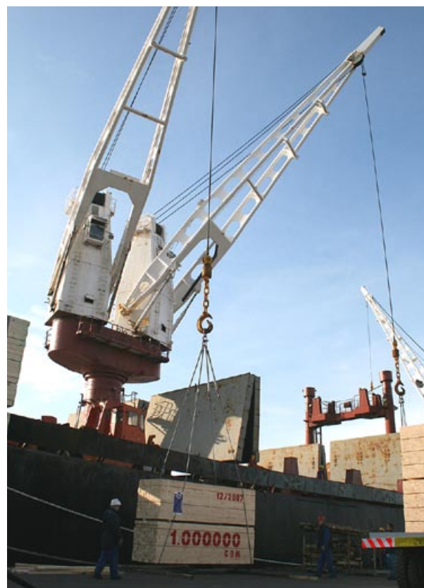
■ Slika 3. Običajen način nakladanja lesa z jeklenimi vrvmi – na sliki tudi jubilejni paket (foto: Ferdo Morgan)
