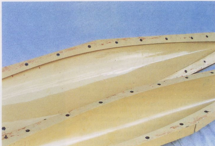
Slika 5. Sijajna notranja površina končanega orodja za jadrično razreda M zagotavlja brezhibno površino izdelka.
