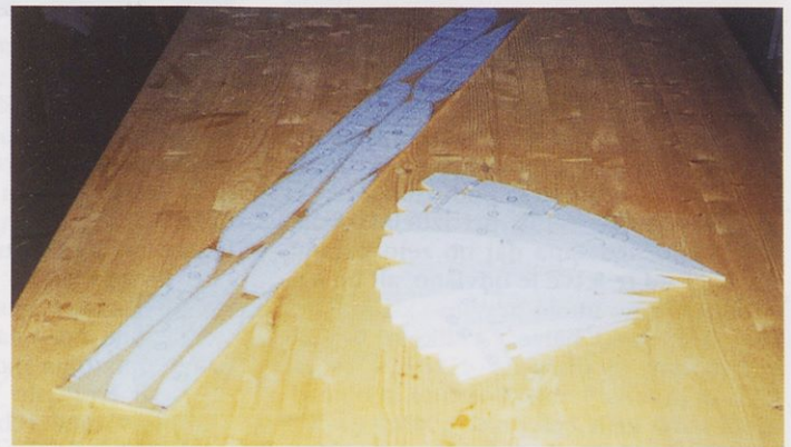
Slika 5. Za razrez pripravljena in že izrezana rebra krila
