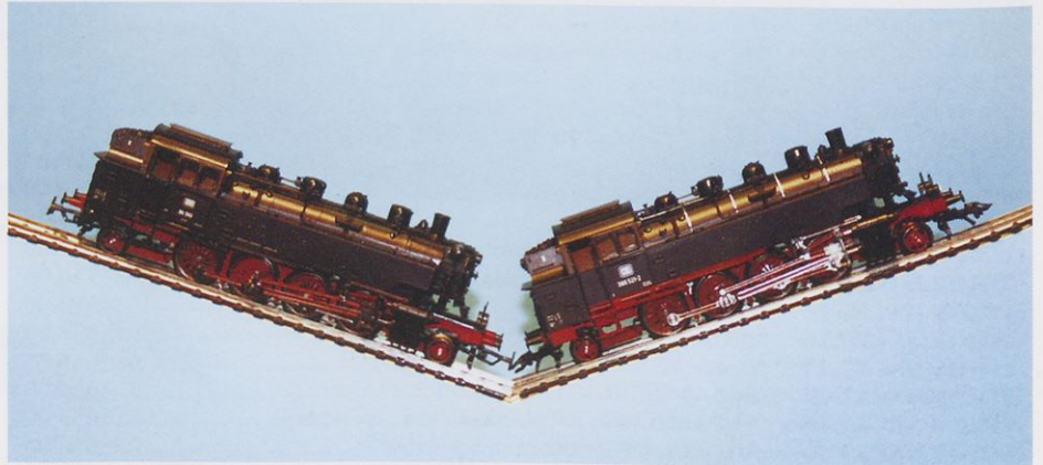
Märklinov digitalni sistem omogoča, da lahko lokomotive, ne glede na obremenitev, vozijo s konstantno hitrostjo navkreber in navzdol.
