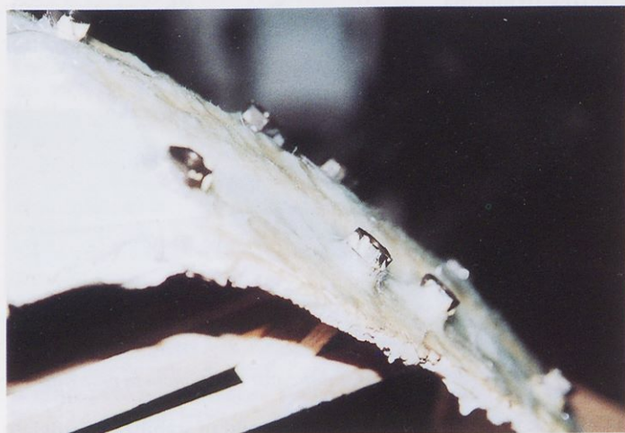
Slika 1. Na steklene sekance položimo prvo plast 110-gramske tkanine. Dobro vidimo navojne matice in centriralne puše, ki bodo po končanem laminiranju del orodja.
