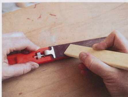
Slika 12. Brušenje letvic pod kotom 45°
