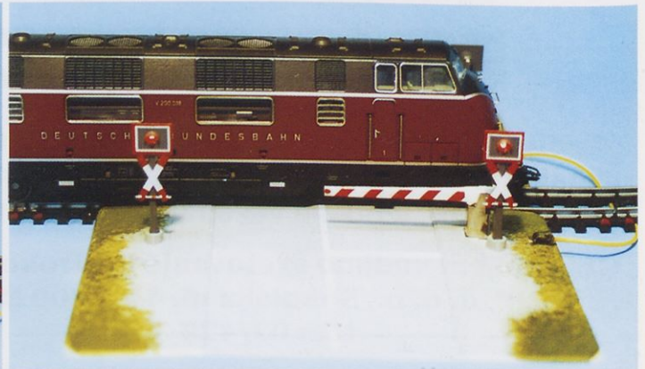
Cestno-železniški prehod se zapira in odpira s pomočjo neizoliranih koles na vlaku in na eni strani izoliranega tira. Sistem se lahko uporablja tudi namesto reed-kontaktov.
