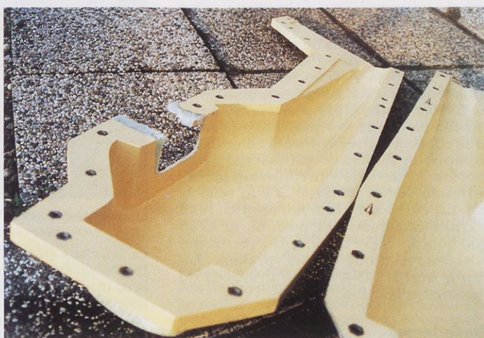
Slika 6. Na sliki sta obe polovici orodja za letalski trup. Centrirni vijaki, puše in navojne matice so del orodja. Površina je sijajna, na orodju pa je treba obdelati še zunanje robove pri kabini.
