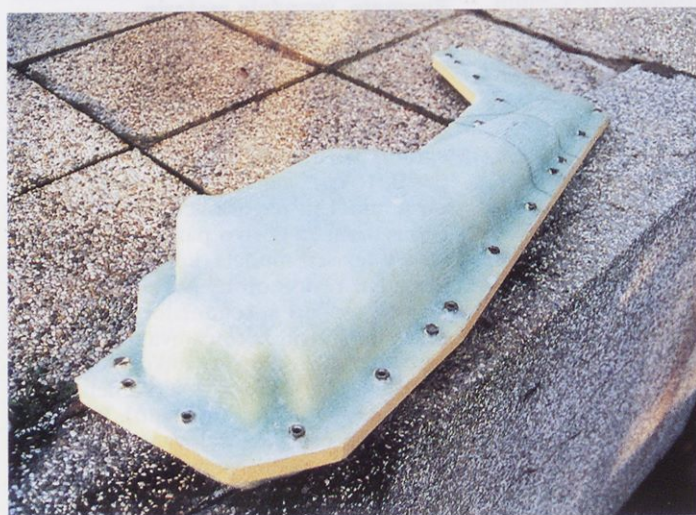
Slika 2. Polovico orodja bomo previdno odstranili z delilne ravnine. Pri tem pazimo, da pramodela ne ločimo od orodja.
