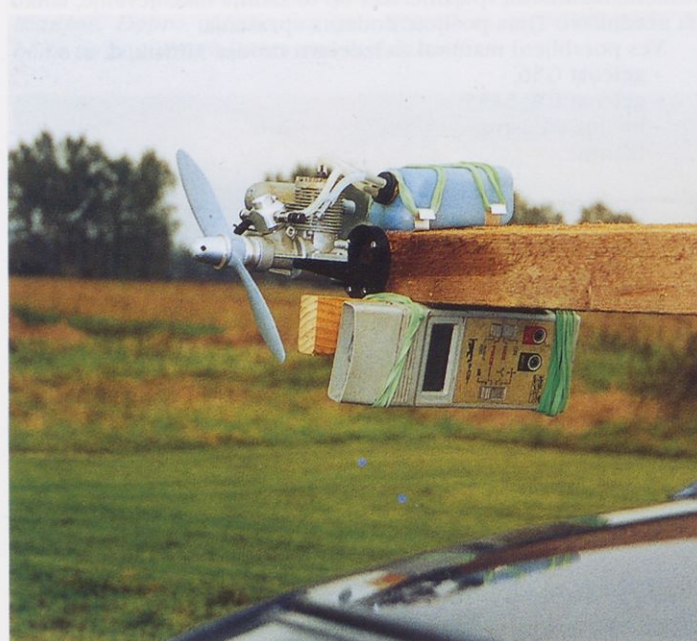
Slika 4. Motor, montiran na streho avtomobila
