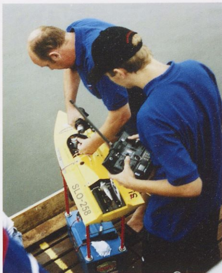
Marko in Rado Koban ogrevata motor modela FSR-V 3,5 in preverjata delovanje radijskega vodenja.
