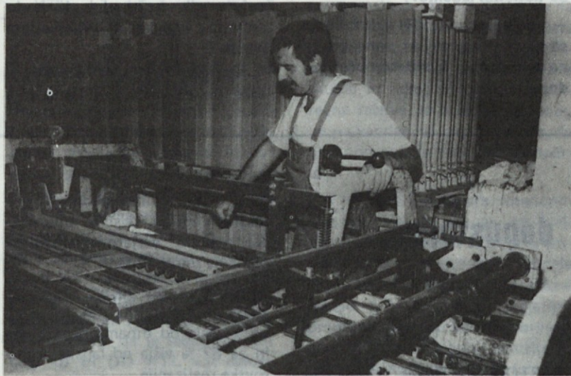
Janez Stavin — strojnik spremlja delovanje lepilnega avtomata "DI-ANA" za večtočkovno lepljenje
