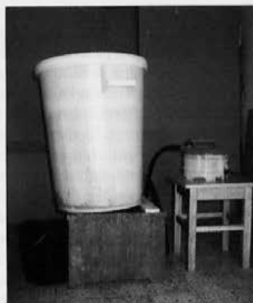
Parni topilec voščin z ločenim uparjalnikom
