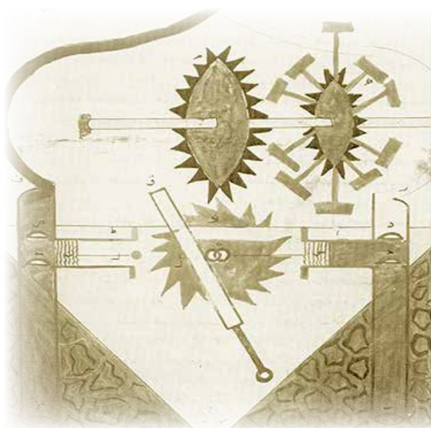
Slika 10 : Al-Jazarijeva dvojna, recipročno delujoča črpalca z ročično gredjo; originalna risba (levo) in CAD risba črpalke (desno); [18]
