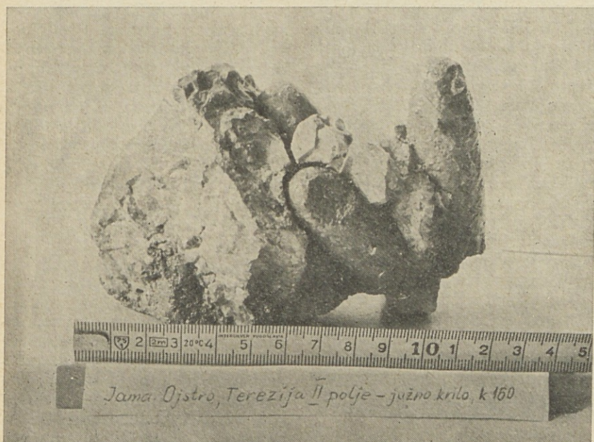
S peščeno glino zapolnjene izvrtine kamenovite školjke Lithodemos lithophagos v triasnem dolomitu. (Foto A. Bregant)
