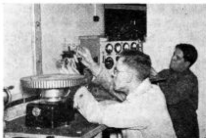
Montaža snemalne aparature za voščene plošče in pripadajočega ojačevalca. Za zvočnikom je videti napravo za svetlobne signale
