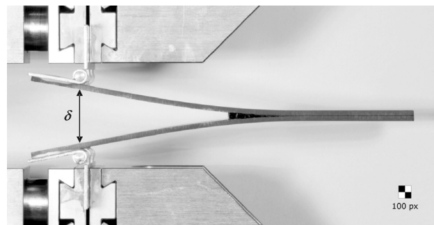
Figure 3: DCB specimen experimental setup Slika 3: DCB-vzorec z eksperimentalno postavitvijo
