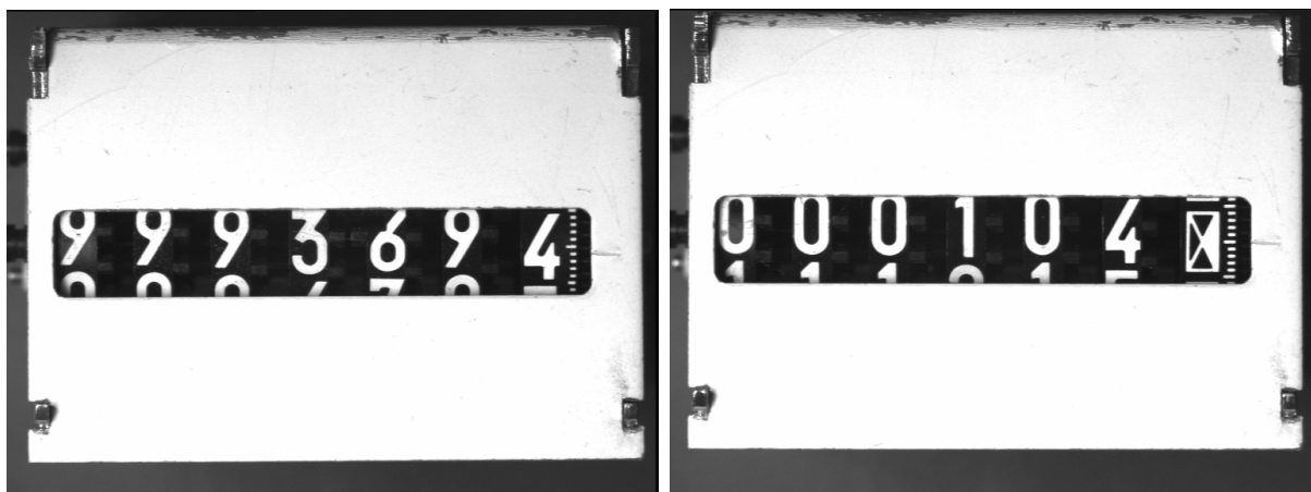
Slika 3: Števec z arabsko (levo) ter kodirano (desno) decimalnko
