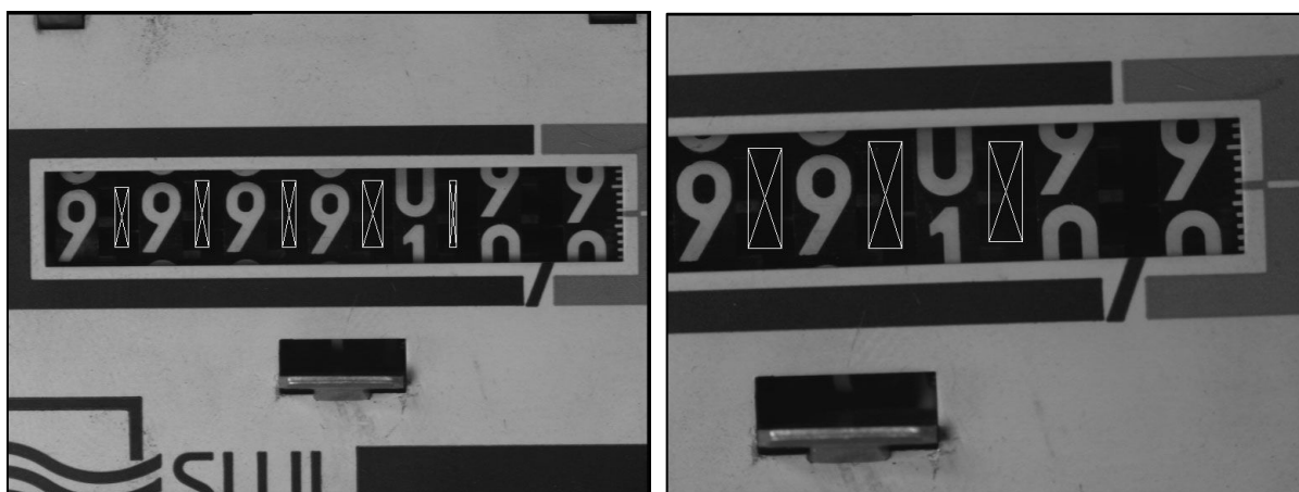
Slika 39: Področja, kjer bomo iskali točke na mejah števnikar (levo manjša, desno večja povečava)
