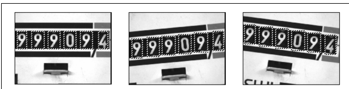
Slika 46: Območja števk pri različnih rotacijah števnik (od leve proti desni: vodoravni položaj, zasuk protiurno, zasuk sournjo)
