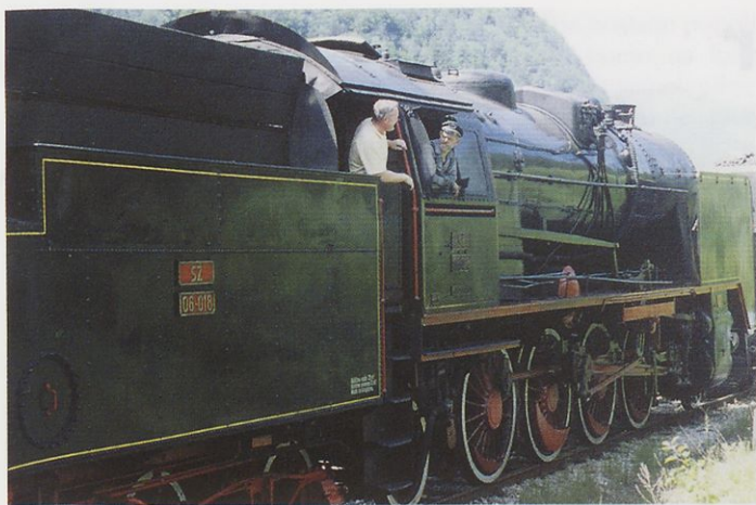
Parna lokomotiva SŽ 06-018, izdelana leta 1930 v tovarni Borsig v Berlinu, je bila nekoč namenjena vleki brzotlakov.
