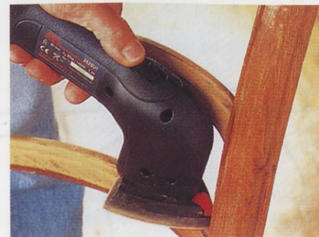
Slika 12. ... ali stolov, saj zaradi trikotno oblikovane brusilne površine omogoča tudi obdelovanje tistih mest, ki se jih z drugimi brusilniki ne da brusiti.
