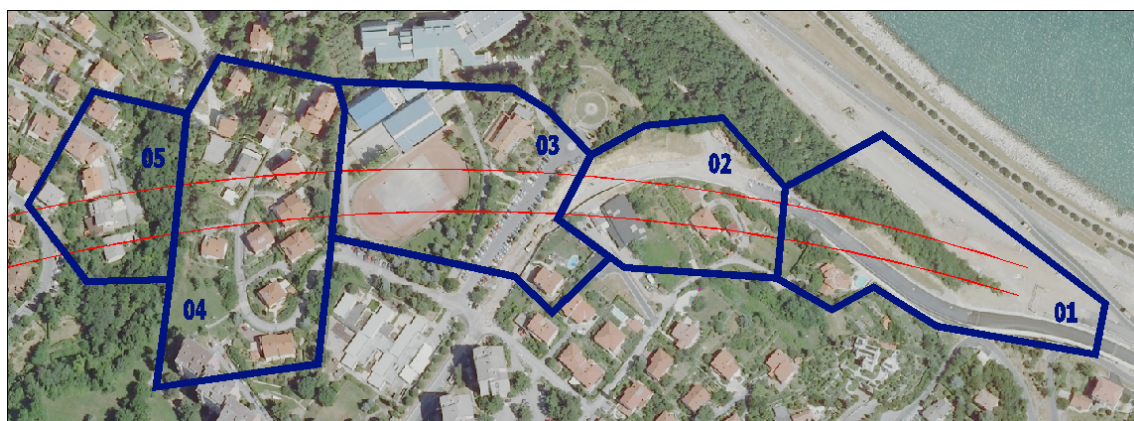
Slika 40: Sektorji izbrani za spremljanje posledic gradnje. Do sedaj je bil izkopan samo sektor 1, zato bo analiza deformacij v nalogi omejena zgolj na to območje.
