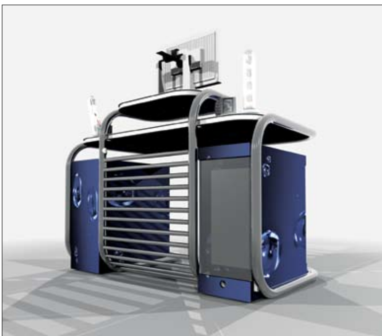
Končna različica računalniške mize CoolIT je izdelana iz kombinacije kovinske cevne konstrukcije, lesene delovne površine in iz lesenih pohištvenih elementov.
