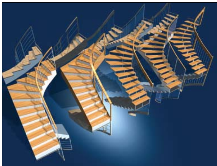
4 Osnovnih 5 tipov izvedbe stopnic, katerim lahko natančno nastavljamo vse parametre in materiale.
