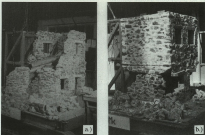
Slika 2: Porušitev modelov kamnitih hiš med preiskavo na potresni mizi.
