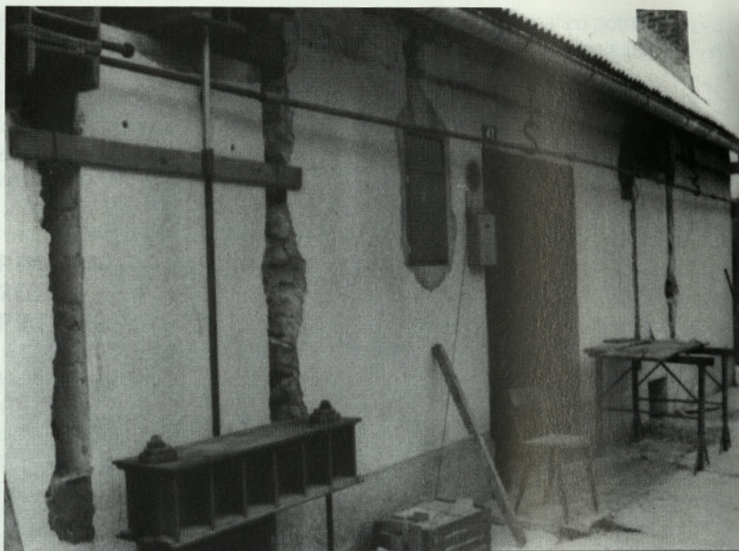
Slika 4: In situ preiskava potresne odpornosti zidu v hiši Kai-Koritnica 47
