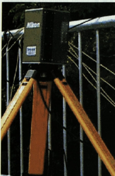
Slika 1: Laserski senzor NIKON-EPS 02A
