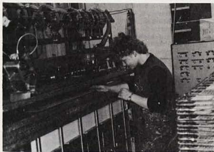
Proizvodnja je stekla tudi na novem sitotisk stroju za drsne obloge. (Konstruktor Rudi Kokalj)
