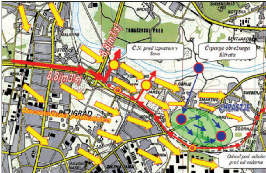
Slika 8 • Predlog aktivne zaščite podtalnice pri črpališču Hrastje
