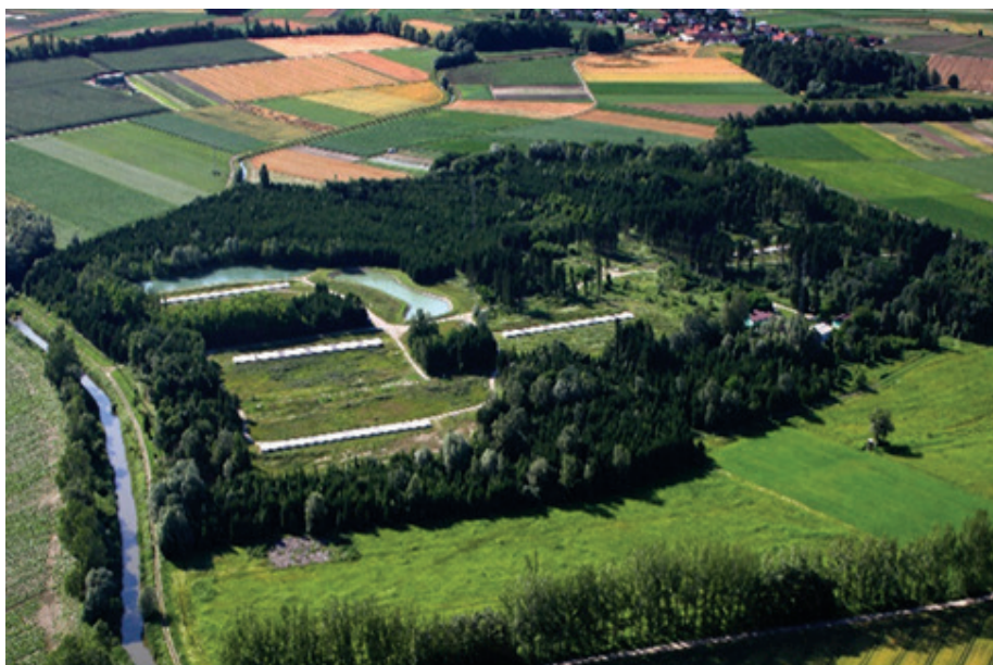
Slika 27 • Pogled na vodne bazene in ponikalna polja za bogatenje podtalnice vodovoda Ormož pri Mihovcih.
