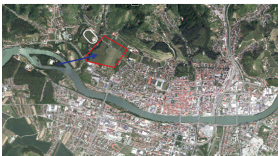
Slika 12 • Območje vodarne na Vrbanškem platoju v neposredni bližini mesta Maribor je po načrtu (slike 13 do 18) zaščiteno pred vplivi iz mesta. Podtalnica se po načrtu bogati z obrežnim filtrom iz Mariborskega otoka, obrežnih vodnjakov Drave in po potrebi z očiščeno dravsko vodo (slika 14). Izvedeno pa je le bogatjenje z obrežnim filtrom in iz Mariborskega otoka.
