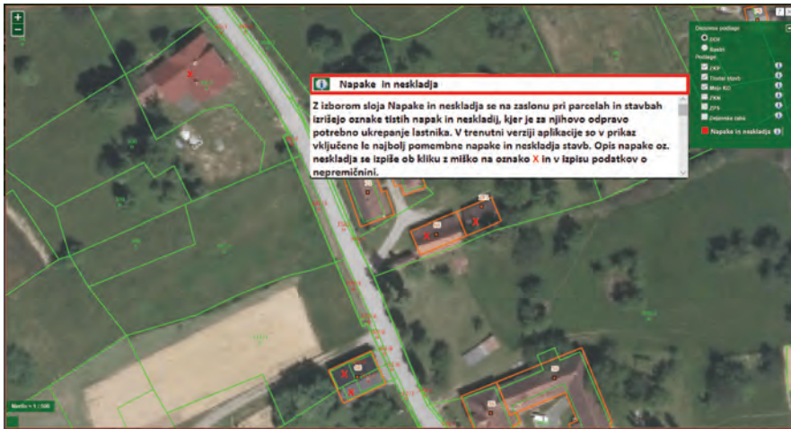
Slika 2: Aplikacija Javni vpogled v podatke o nepremičninah: zamisel o vključitvi sloja napak in neskladij kot ene od možnosti za sloje javnega vpogleda – z rdečim X so označene stavbe z neskladji.
