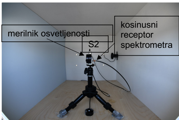
Slika 32: Fotografija eksperimentalne postavitve v notranjosti modela. Figure 32: Picture of experimental setup in the model interior.
