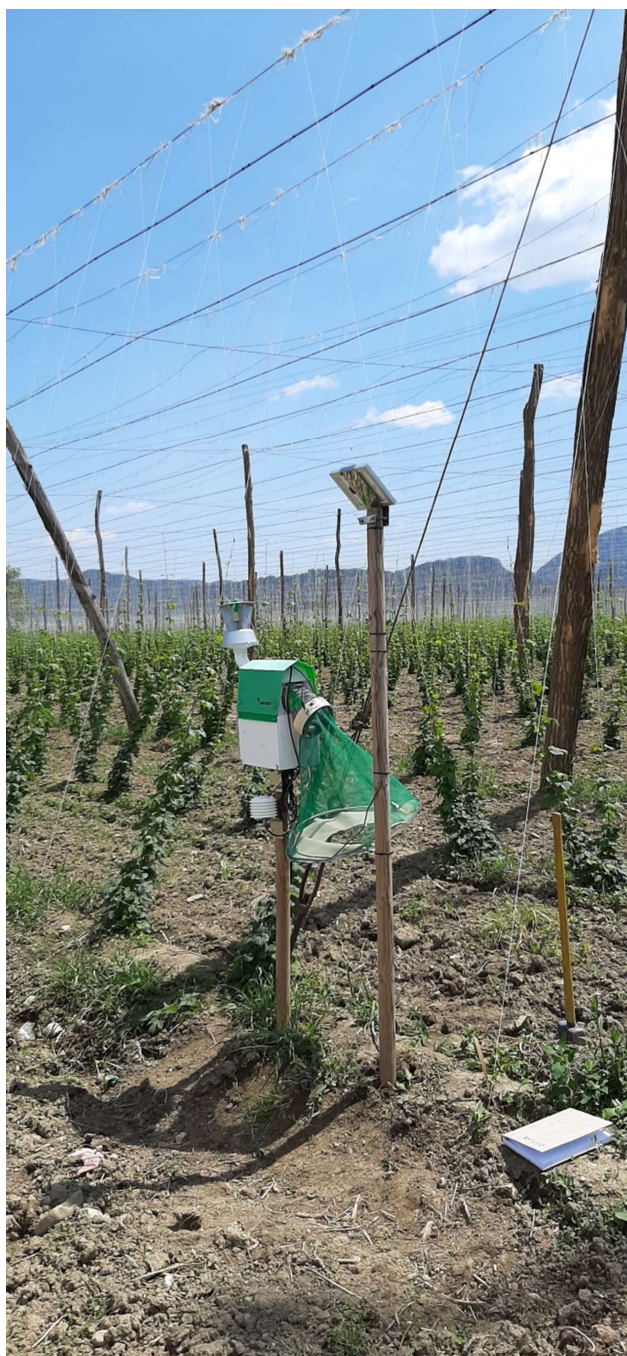
Spremljanje koruzne vešče s svetlobno vabo Trapview AURA, opremljeno s stožčasto mrežo in dodanim feromonom (Foto: F. Poličnik)
