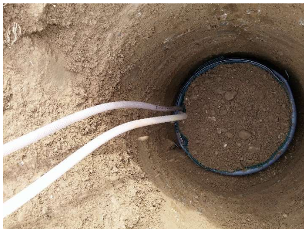
Eden izmed štirih vstavljenih lizimetrov pred zasutjem (Foto: B. Naglič)
