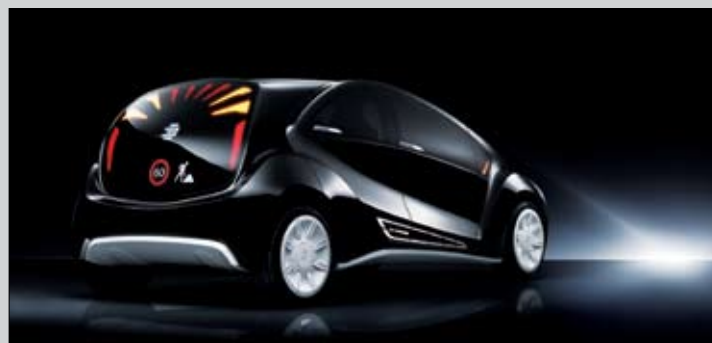
Konceptno vozilo s karoserijo iz nove vrste bazaltnih vlaken
