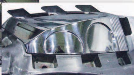
» Orodja za brizganje plastike, izdelana iz materiala proizvajalca Böhler M 268, ki se uporabljajo za izdelavo avtomobilskih svetil, z zahtevanim visokim sijajem polirane površine
