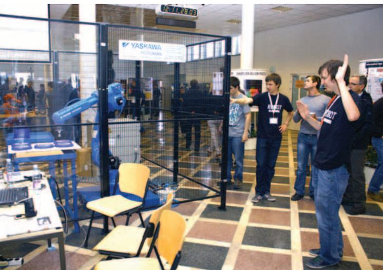
› Vodenje robota z zaznavalom gibanja Kinectom (foto: Bojan Sitar)
