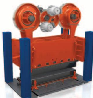
» Slika 3: Servostiskalnica; pogonski mehanizem
