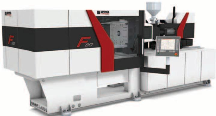
Med drugim bo na sejmu predstavljen izjemno hiter stroj za brizganje serije F, in sicer F 80, z zapiralno silo 800 kN, napredno brizgalno enoto AP in polžem premera 40 mm. Stroj lahko doseže hitrosti do 500 mm/s, osi stroja pa poganja hidravlika ali elektrika. Na njem bo potekala izdelava okroglih pokrovov za embalažo za mlečne izdelke, ki se jo lahko večkrat uporabi.
