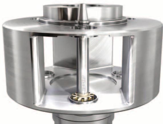
► Obdelava očes na nosilcu planetnih zobnikov z rezkarjem Iscar Polymill, ki se odlikuje z visoko stabilnostjo in manjšimi rezalnimi silami. (Slika: Iscar)
