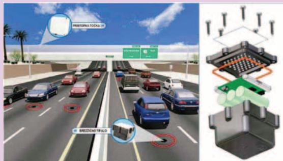
običajno montirana na semafor, z miniračunalnikom Linux in oddajnikom, ki podatke o obsegu in gostoti prometa ter hitrosti pošilja prek interneta ali omrežja Ethernet, v prihodnosti tudi z neodvisnim navigacijskim sistemom. Večina tipal kar 99 odstotkov časa spi. Vozilo nad tipalom vpliva na Zemljino magnetno polje, kar ga zbudi. Za
