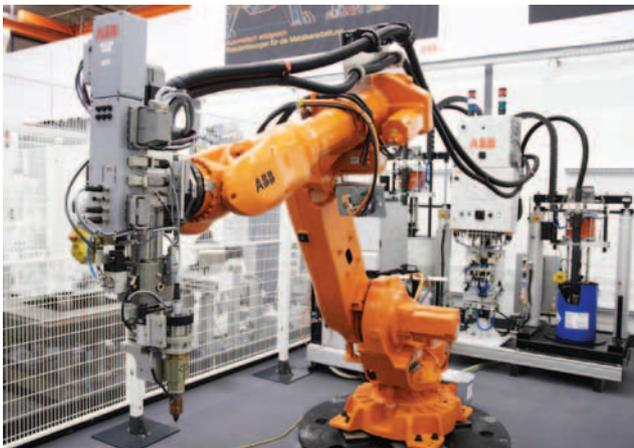
› Novi roboti za nanos lepila izpolnjujejo visoke zahteve glede hitrosti in natančnosti doziranja lepila na pravo mesto. (Foto: ABB Automation GmbH)
