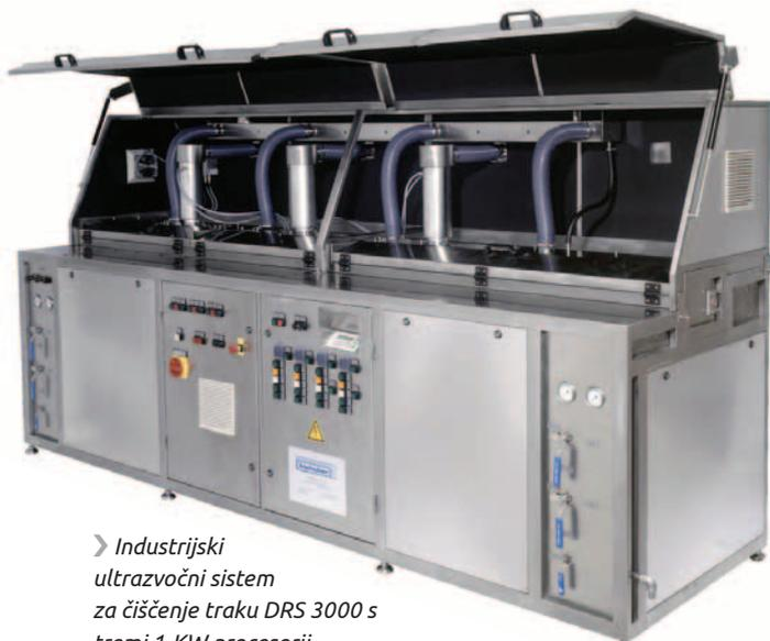
› Industrijski ultrazvočni sistem za čiščenje traku DRS 3000 s tremi 1-KW procesorji
