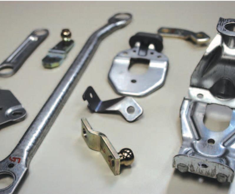
► Eponsa proizvaja vse dele za mehanizme brisalcev vetrobranskega stekla s preoblikovanjem pločevine.
