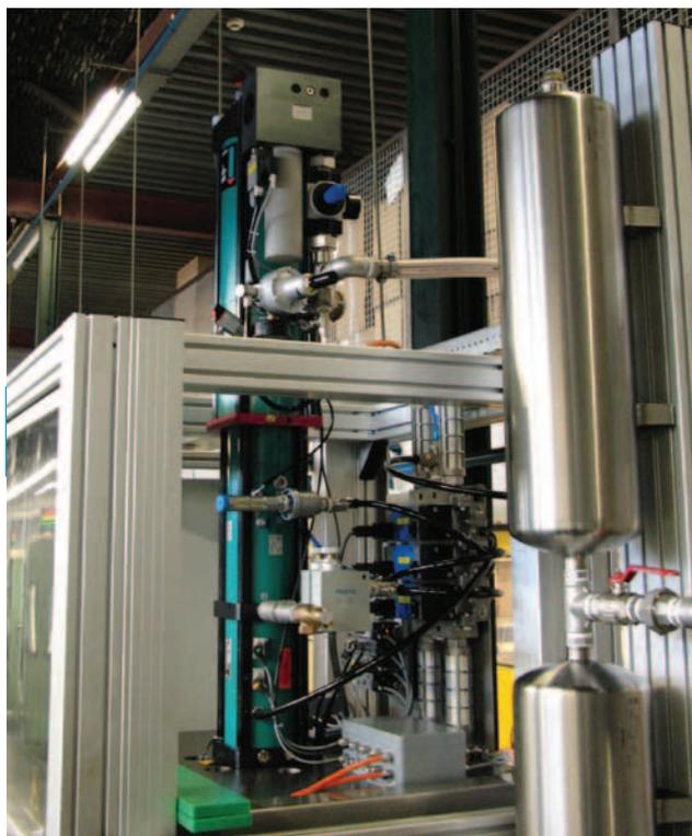
» Slika 2: Stiskalnica TOX® MAG 015 s pnevmohidravličnim delovnim valjem pogonskega paketa TOX®
