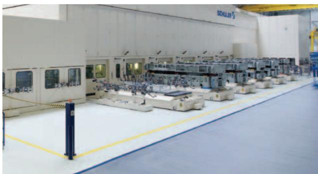
» Slika 2: Linija s servopogoni; izvedba s transfornimi orodji
