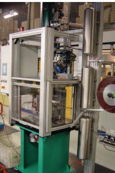
» Slika 1: Stiskalnica TOX® MAG 015 s pnevmohidravličnim delovnim valjem pogonskega paketa TOX®
