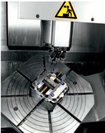
» Petosna kompletna obdelava zahtevnih komponent za prototipe vseh velikosti, koncept stroja s tremi osmi (X, Y in Z) v orodju in dvema osema v obdelovancu (vrtljni osi A in C) omogoča vedno optimalen dostop.
